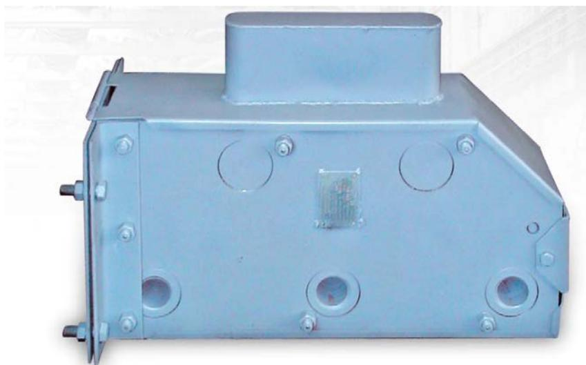
Амортизаторы устанавливаются на подшивных или специальных площадках копра и служат для погашения кинетической энергии улавливаемой клетки и обеспечения плавного торможения их с заданным замедлением. Перемещением сухарей относительно валков осуществляется перегиб амортизационных канатов, что создает необходимую величину тормозного усилия.
