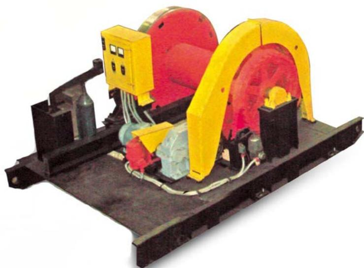
Лебедка проходческая предназначена для спуска и подъема проходческого оборудования и материалов при проходке, углубке, армировании и ремонте вертикальных стволов шахт с установкой на поверхности.
