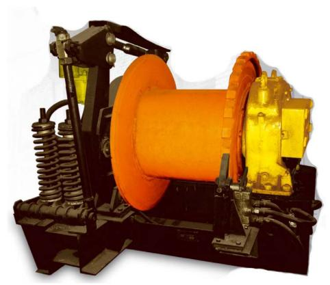
Лебедка проходческая с пневматическим приводом предназначена для спуска и подъема проходческого оборудования при проходке, углубке, армировании и ремонте стволов шахт с установкой в подземных выработках или на поверхности.
