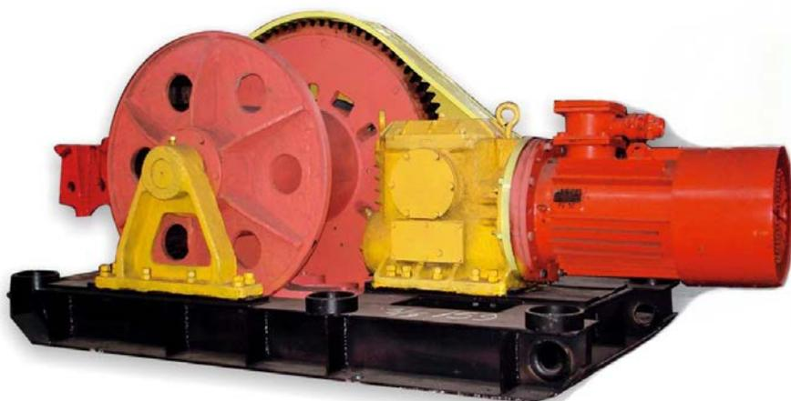
Предназначена для перемещения грузов по почве. Может использоваться для доставки оборудования к лаве по подготовительной выработке с максимальным углом наклона 15° для установки секций крепи в лаве в рабочее и транспортное положение.
