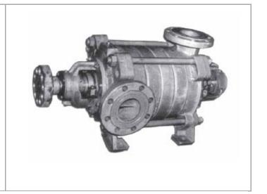
Насосы ЦНСНт 105-98... 441, ЦНСНт 180-85... 383, ЦНСНт 300-120... 540 предназначены для перекачивания обводненной газонасыщенной и товарной нефти с температурой от 275 К (1°С) до 318 К (45°С) в системах сбора и транспорта нефти внутри промысла. Допускается перекачивание нефти с температурой до 333 К (63°С) при условии применения принудительного охлаждения подшипников.
