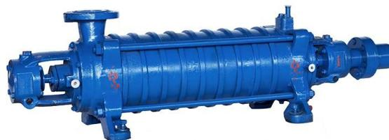
Насосы ЦНС 13-70...350, ЦНС 38-44...220, ЦНС 60-66...330 предназначены для перекачивания воды с водородным показателем рН 7-8,5, с массовой долей механических примесей не более 0,1% и размером твердых частиц не более 0,1 мм и температурой от 1 до 45 °С.
