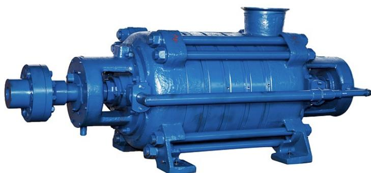
Насосы ЦНС 60-50... 250 предназначены для перекачивания воды с водородным показателем рН 7-8,5 с массовой долей механических примесей не более 0,5% и размером твердых частиц не более 0,2 мм, плотностью не более 1500 кг/м<sup>3</sup> и температурой от 1 до 45 °С.
