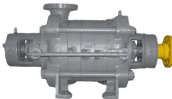
Насосы ЦНС 500-160... 880 предназначены для перекачивания воды с водородным показателем рН = 7-8,5, температурой от 1 до 45 °С с содержанием механических примесей не более 0,5% по массе, размером твердых частиц не более 0,2 мм. Заводом освоено специальное исполнение насосов для последовательной схемы работы ("насос в насос") с допускаемым давлением на входе до 64 кг/см<sup>2</sup> и конечным давлением на выходе до 160 кг/см<sup>2</sup>. Обозначение исполнения ЦНС 500-160... 880-1.
