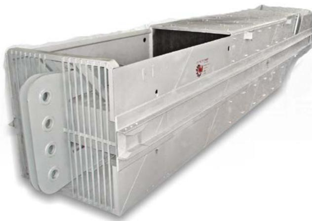
Скип шахтный неопрокидной для вертикального многоканатного подъема предназначен для подъема горной массы на шахтах горнодобывающей промышленности со стволами, оборудованными канатными проводниками.
